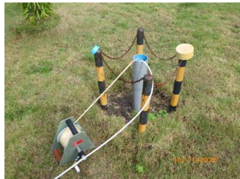
ภาพที่ 2-11 บ่อสังเกตการณ์ (Monitoring Well)
